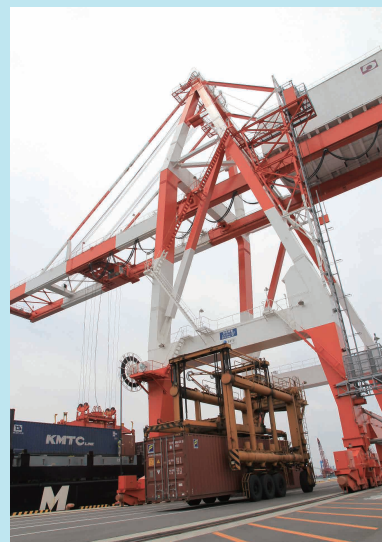
現在配備しているガントリークレーンとストラドルキャリア
