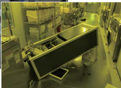
装置に付帯する転倒した通信制御ユニット
