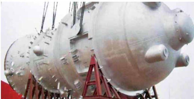
FCCリアクター。石油プラントなどで使用されるプロセス機器
