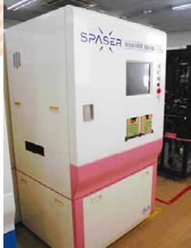
使用済注射薬自動認識システム「SPASER(スベイサー)」
