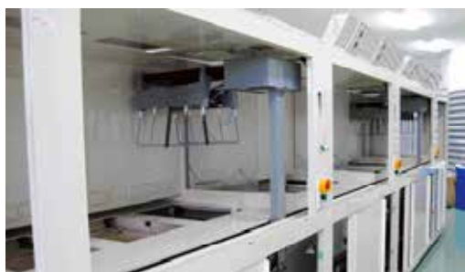
12インチウエハー対応の全自動レジスト剥離装置 設計から製作・据え付けまでを行っている
