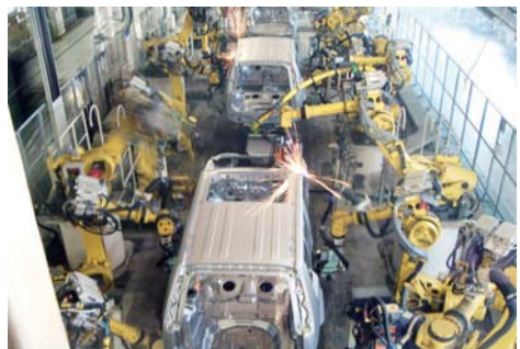
日産自動車九州(株)の全自動ロボットによる溶接ライン
