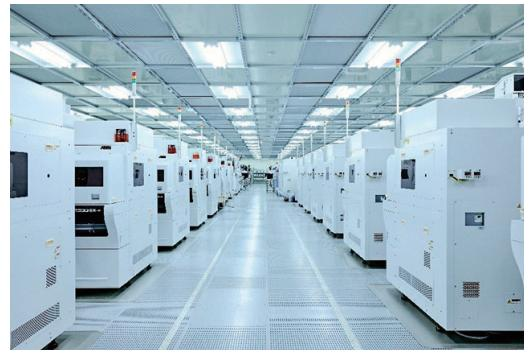
▲半導体の電気特性を検査するための装置「テスタ」
