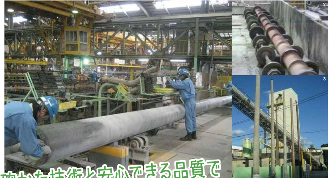
1: 製品のコンクリートボール仕上作業 2: 選心締め締め作業。この中でコンクリートボールが造られている 3: 完成したコンクリートボール
