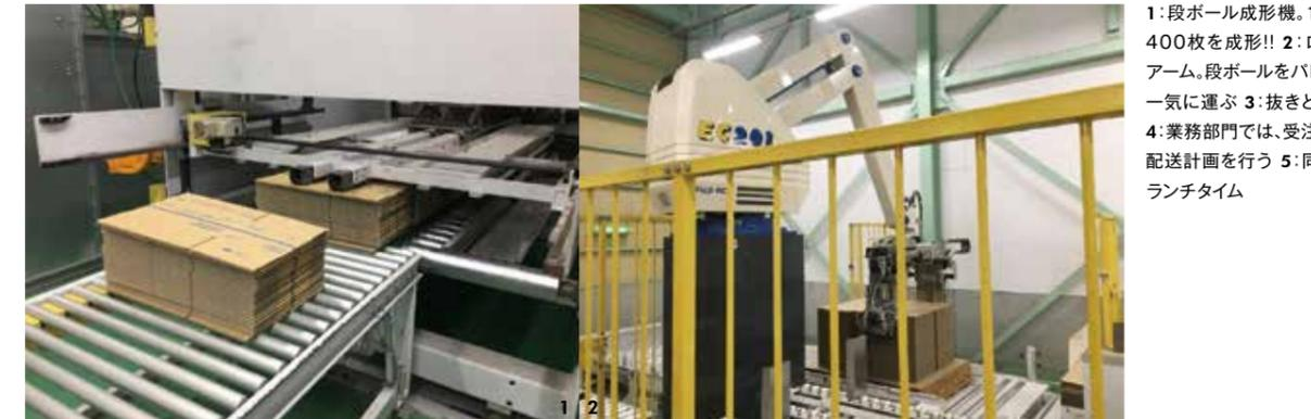
1:段ボール成形機。1分間に400枚を成形!! 2:ロボットアーム。段ボールをパレットに一気に運ぶ 3:抜きとり検査 4:業務部門では、受注・製造・配送計画を行う 5:同僚とのランチタイム
